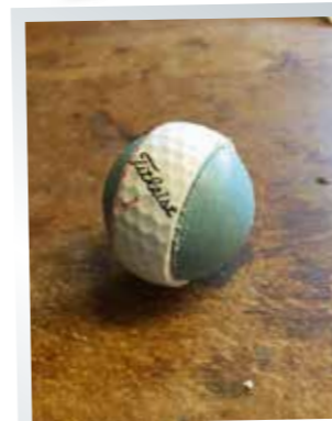
Freistellung des vorher festgelegten Ausschnitts eines zweischaligen Golfballs
