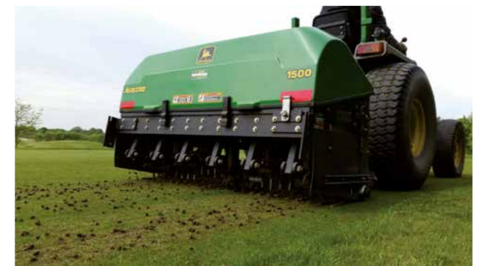
Ein „Aercore Aerifizierer“, eine Maschine, die alten Rasenfilz und Erde aus dem Boden zieht
